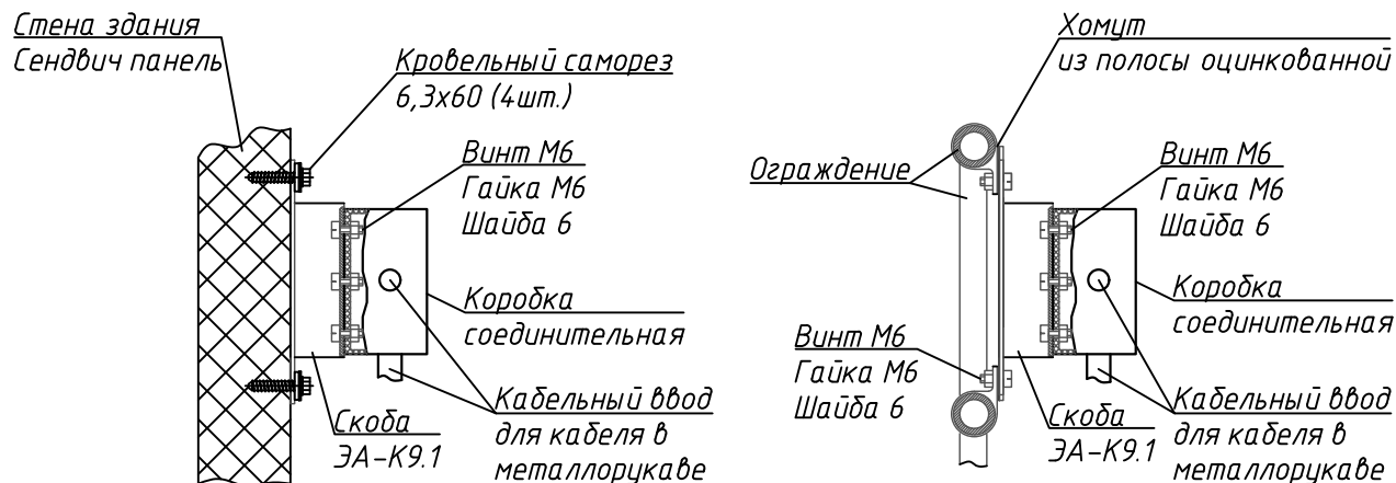
Рисунок 6.1 – Монтаж соединительных коробок к стене здания и на ограждении снегозадержания
